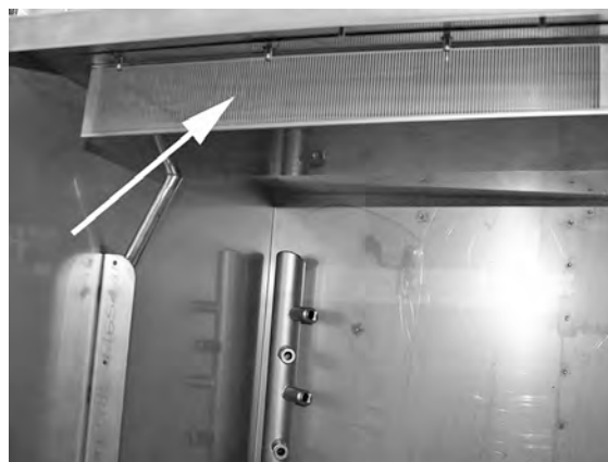
obraz 45 EcoExchanger widoczny wewnątrz kabiny urządzenia.
