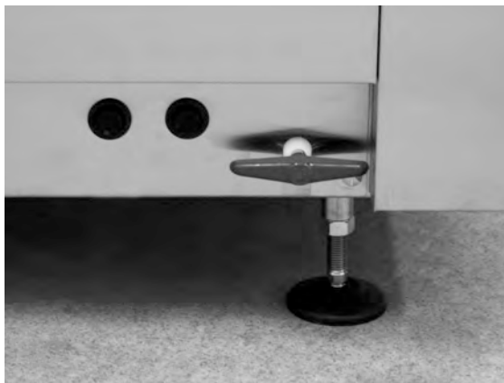
obraz 26 Dostęp do zabezpieczeń przed przegrzaniem
