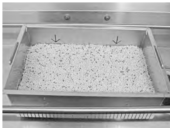
Figura 33 Controllare il livello dei Granuli
