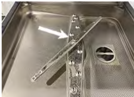
Kuva 14 Alemmat pesu- ja huuhteluvarret
