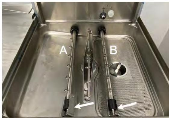
**Figura 23 Rimuovere i bracci di lavaggio pentole**
