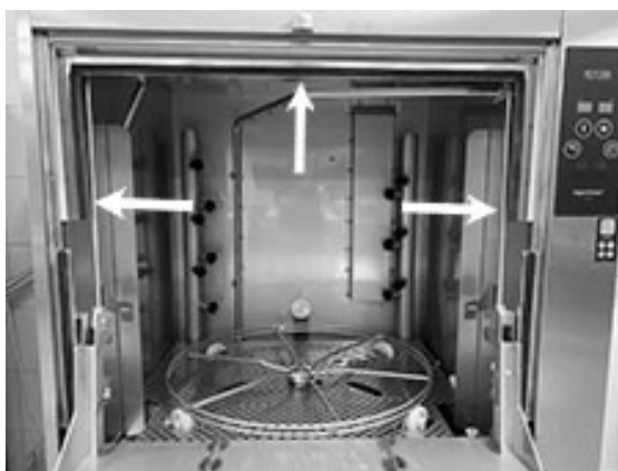
obraz 33 Ramka drzwi do wyczyszczenia.
