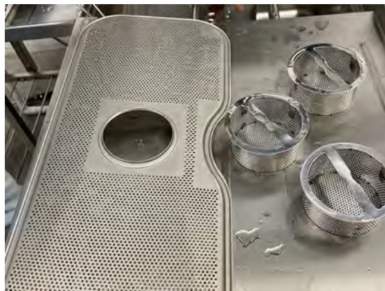
Figure 28 Почистване на филтрите и решетката на резервоара
