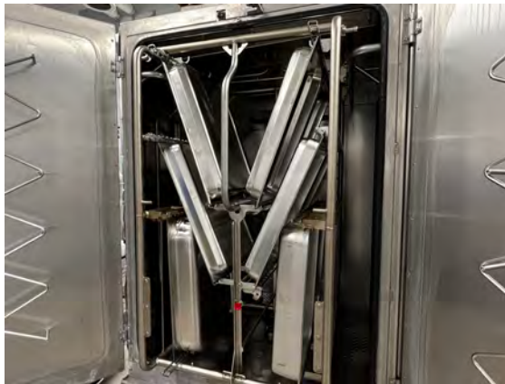
obraz 6 Wkładanie naczyń do zmywarki
