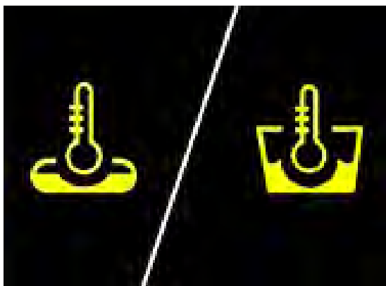
obraz 8 Wyłącznik termiczny zbiornika mycia lub płukania
