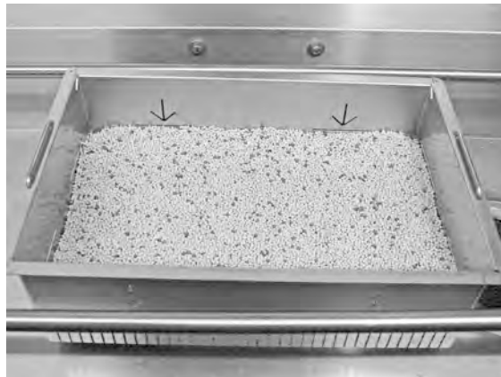
Figura 26 Controllare il livello dei granuli
