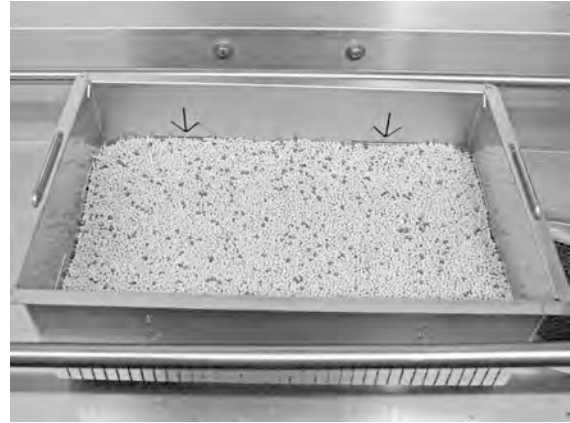
Fig. 31 A granulátumszint ellenőrzése
