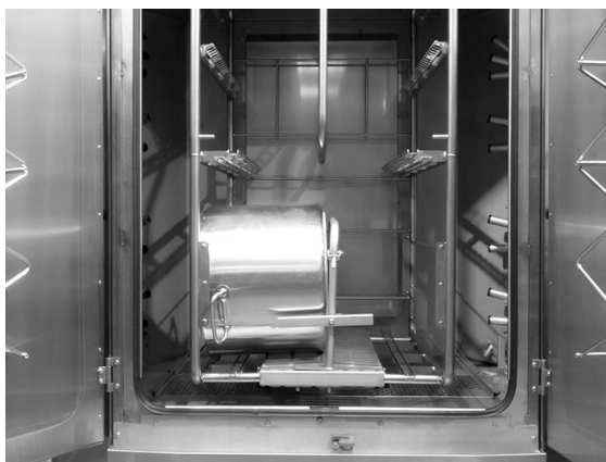
Obrázek 12 Kazeta naplněná jedním velkým hrncem
