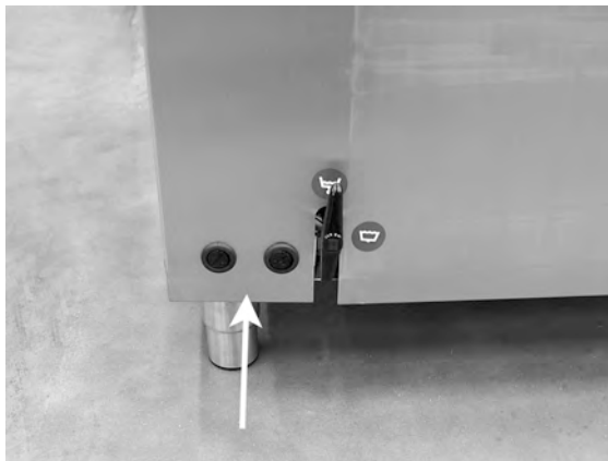
obraz 19 Dostęp do zabezpieczeń przed przegrzaniem
