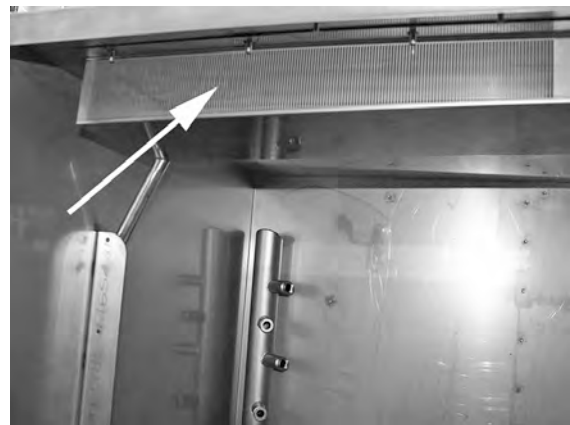
Photo 41 EcoExchanger vu de l'intérieur de la cuve
