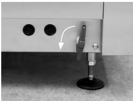
Photo 6 Vanne de remplissage
