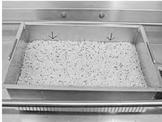
Photo 25 Contrôlez le niveau de Granules
