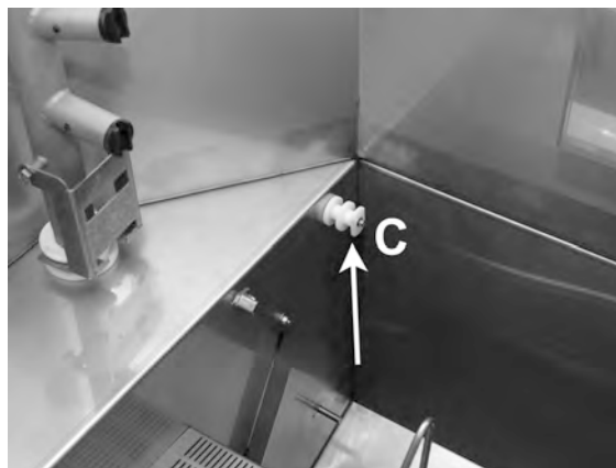
Photo 30 Capteur de niveau
