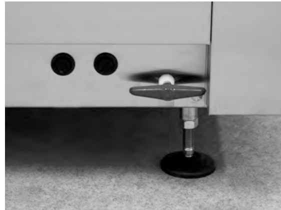
obraz 22 Dostęp do zabezpieczeń przed przegrzaniem
