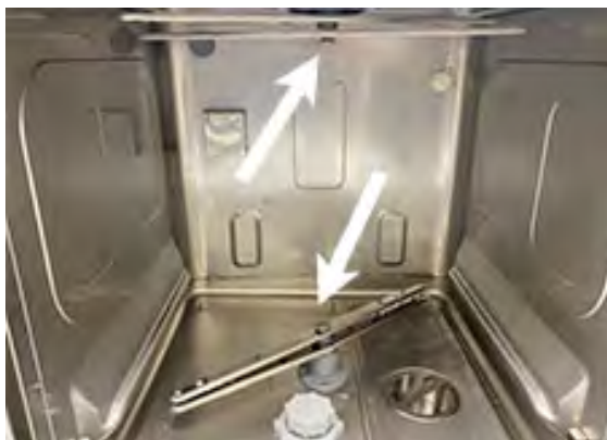
Imagine 18 Brațe de spălare inferioară, superioară și clătire
