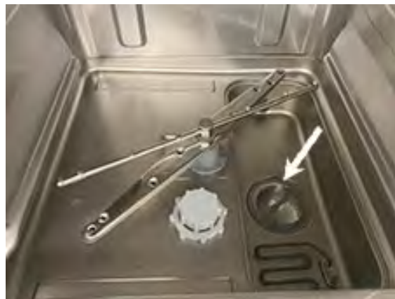
Abbildung 21 Ausbau des Filters
