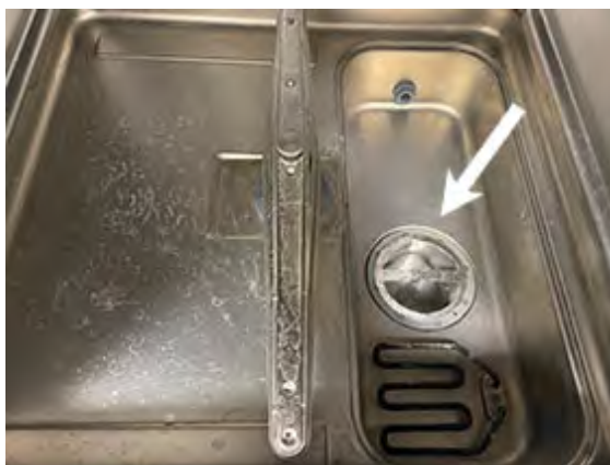
Kuva 14 Suodata tyhjennuspumpun yhteydessä
