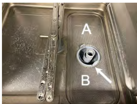
Figura 11 Rimuovere le griglie della vasca e il filtro
