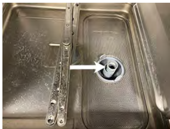
Figura 10 Rimuovere il tubo del troppo pieno
