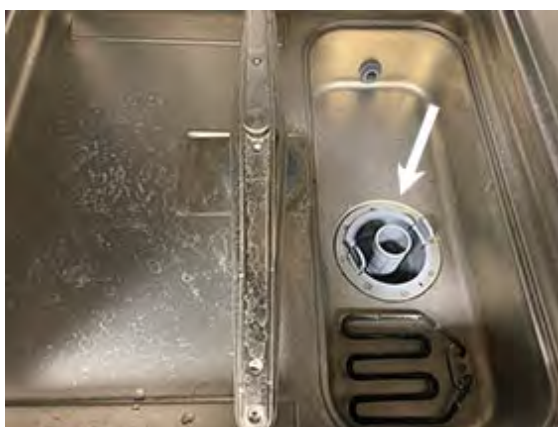
Figura 13 Rimuovere il filtro
