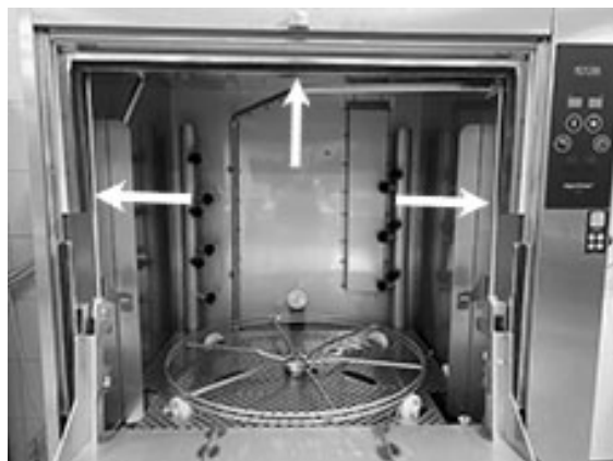
Kuva 33 Puhdistettava oven karmi
