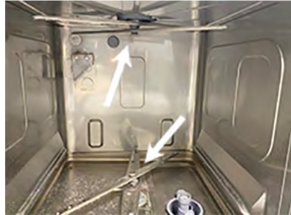
Figure 15 Рамена за измиване и изплакване
