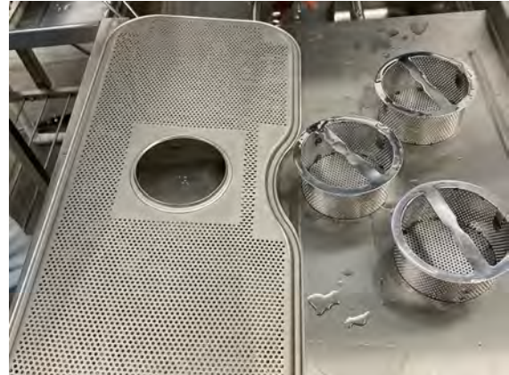
Abbildung 28 Reinigung der Filter und des Tankgitters
