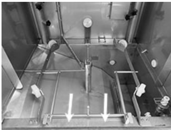
Bild 31 Rengör under kranen
