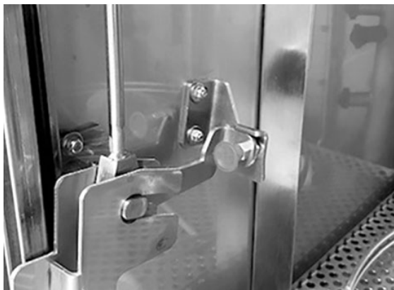
Bild 22 Närbild – se till att armen har låsts ordentligt
