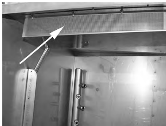
Bild 34 EcoExchanger som den ser ut inuti diskmaskinskabinen
