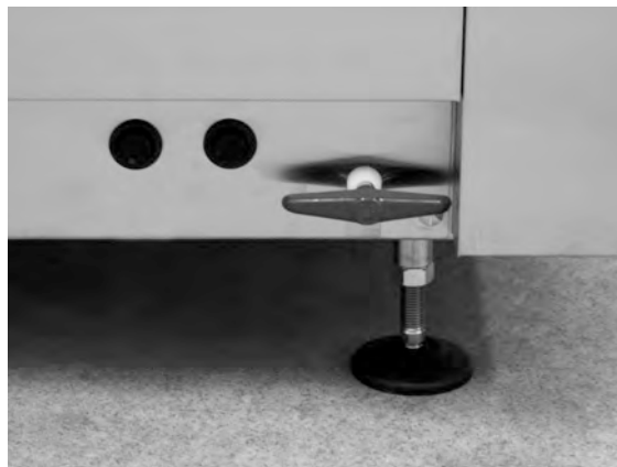
Bild 24 Åtkomst till överhettningsskydden
