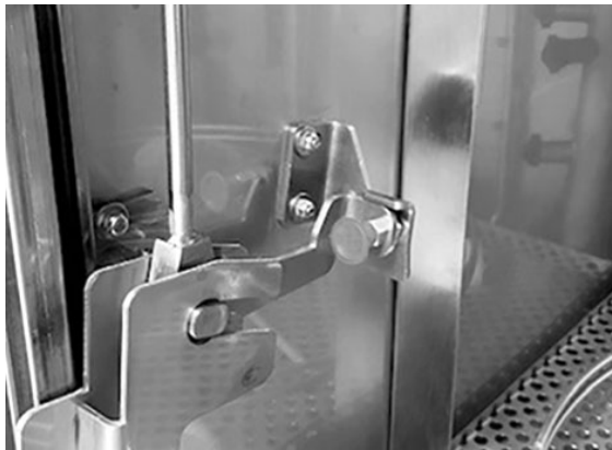
Bild 28 Närbild – se till att armen har låsts ordentligt
