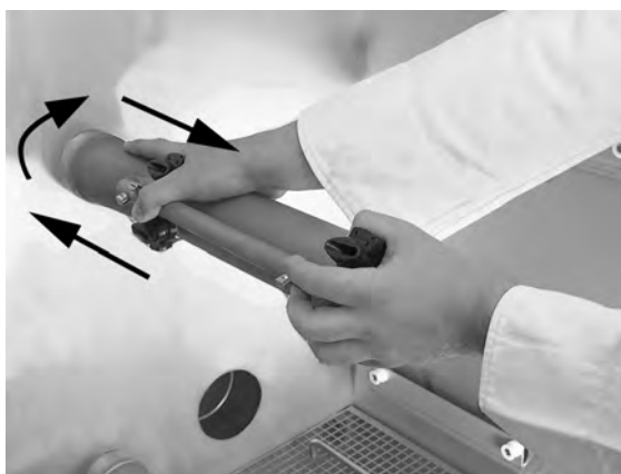
Kuva 30 Sumutusputken asettaminen takaisin paikalleen
