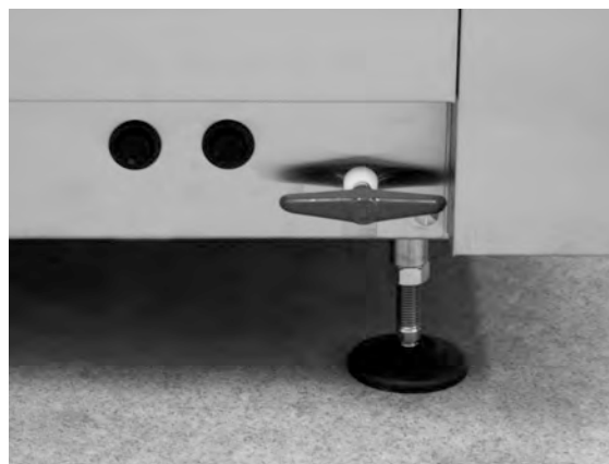
Bild 28 Åtkomst till överhettningsskydden
