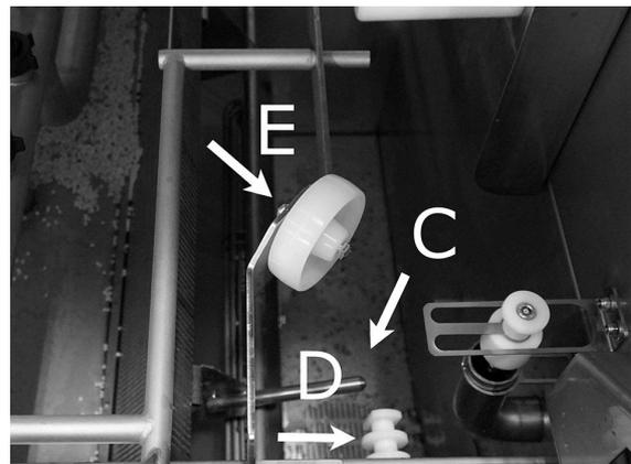
**Photo 42 Le tamis de fond, la sonde de niveau et rouleaux**
