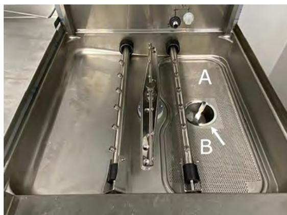
**Photo 24 Retirer la grille et le filtre de la cuve**
