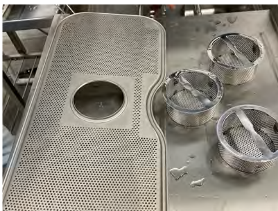
Obrázek 28 Očištění filtrů a mřížky nádrže
