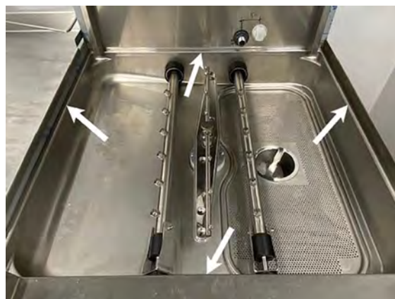
Obrázek 29 Otření okrajů nádrže
