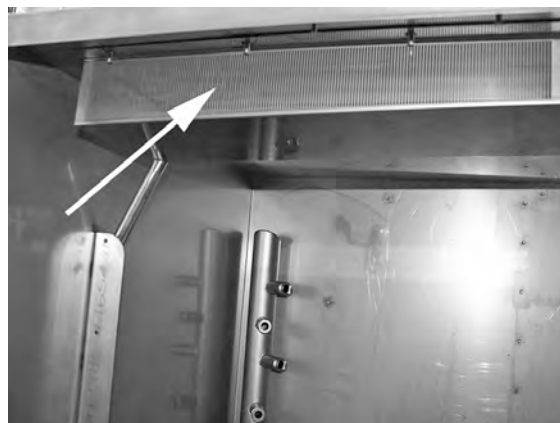
Figure 41 EcoExchanger , гледан от вътрешната страна на корпуса на машината
