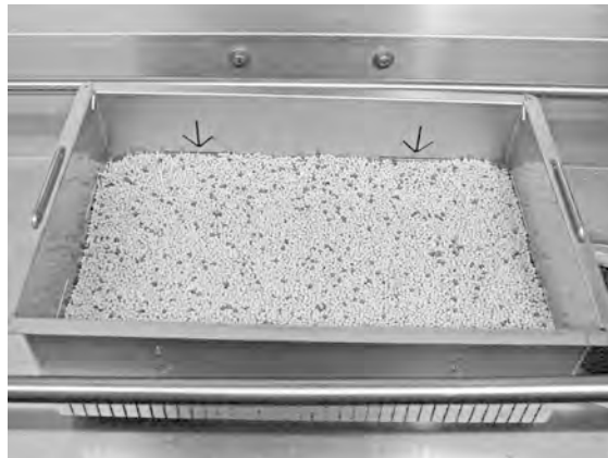
Figure 31 Проверете нивото на гранулите
