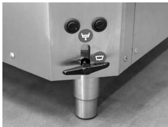
Figure 20 Достъп до протектори срещу прегряване
