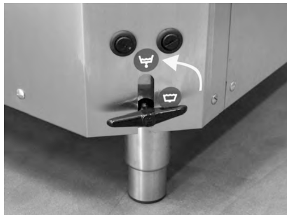
Figure 24 Кран за източване
