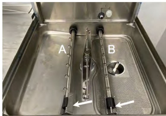
obraz 23 Zdjąć ramiona do mycia naczyń
