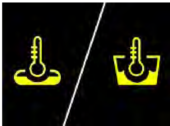
Figura 9 Thermostop vasca di lavaggio o risciacquo
