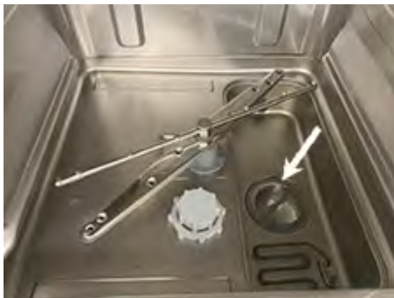
Figura 21 Rimuovere il filtro
