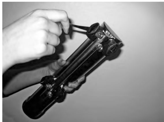
Photo 24 Nettoyage des buses
