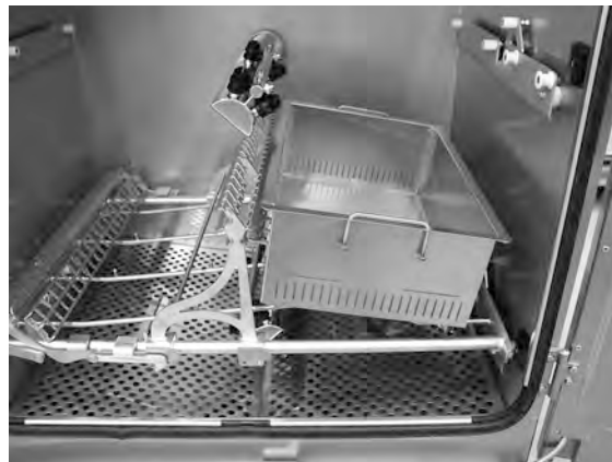
Photo 21 Collecteur de Granules dans la machine
