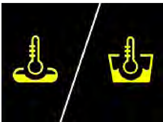
obraz 9 Wyłącznik termiczny zbiornika mycia lub płukania
