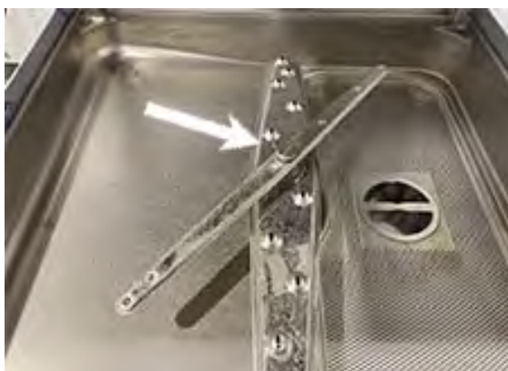
obraz 19 Dolne ramiona natrysznicy myjącej i płuczącej
